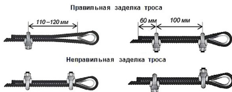
Рисунок 6 – Заделка троса
